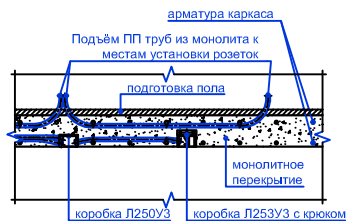
Эскиз 2. Монтаж полипропиленовых труб (ПП), распаечных и установочных коробов в монолите перекрытия (пола).
