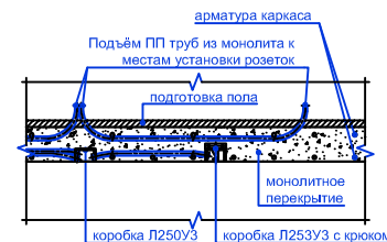
Эскиз 2. Монтаж полипропиленовых труб (ПП), распаячных и установочных коробок в монолите перекрытия (пола).
